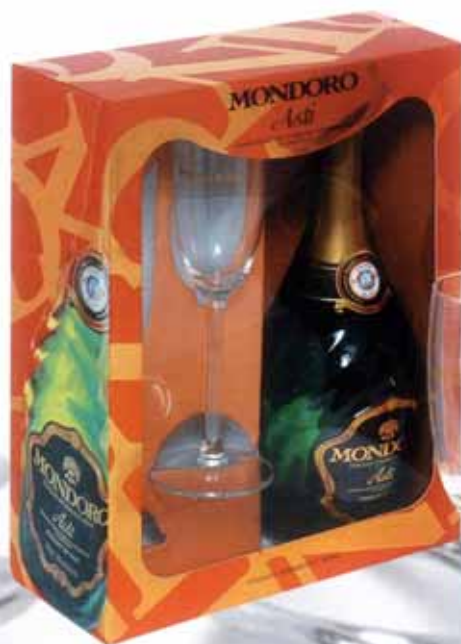
Упаковка набора «Мондоро». Картон 190 г/м 2 , микрофронткартон, вставка ПВХ, офсетная печать УФ-красками, УФ-лак, каширование, вырубка, вклеивание окна, конгрев, склейка
